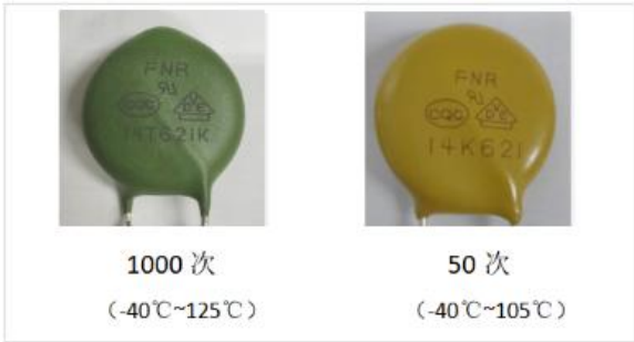
► 图表 3 车规压敏电阻和常规压敏电阻的温度冲击性能对比
